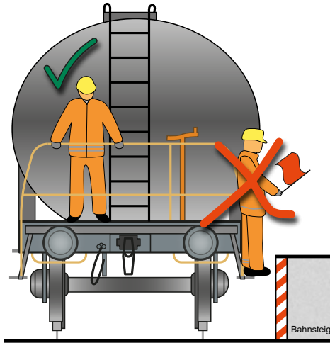
Abbildung 11c: rot/weiß gekennzeichnete Gefahrenstellen
