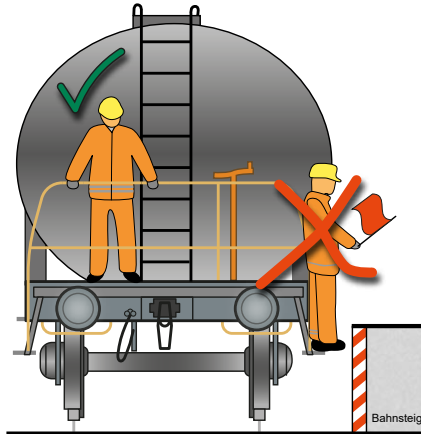
Abbildung 10c: Rot/weiß gekennzeichnete Gefahrenstellen
