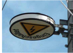
Abbildung 11c und 11d: Schaltzeiger „Oberleitung des Ladegleises ist ausgeschaltet“
