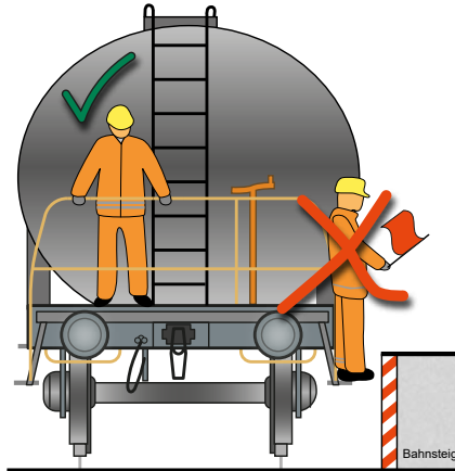
Abbildung 10c: Rot/weiß gekennzeichnete Gefahrenstellen
