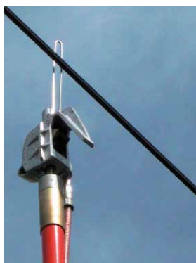
Bild 14d und 14e: Feststellen der Spannungsfreiheit mit Spannungsprüfer bzw Tastspitze
